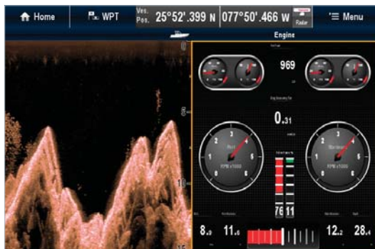
Режим разделенного экрана а7 Series с данными системы DownVision и двигателя
