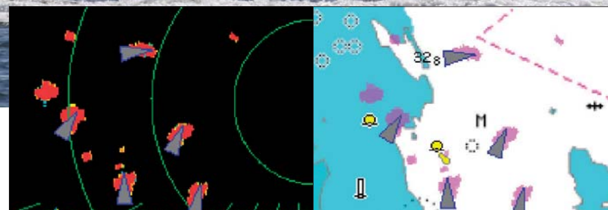
Цели AIS, наложенные на экран радара (слева) и на карту (справа)
