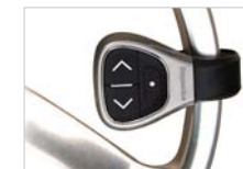
Устройство дистанционного управления RMK-3 на штурвале
